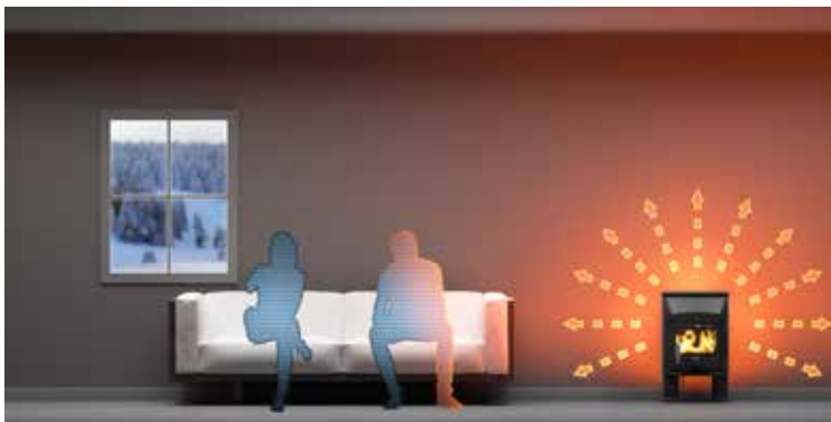
Kaminofen mit Strahlungswärme ohne Konvektion..
